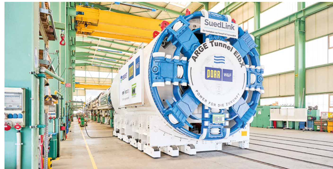
Die Tunnelbohrmaschine ELSA wurde speziell für ElbX konstruiert; sie hat etwa die Ausmaße eines (einteiligen) ICE. Foto: TenneT
