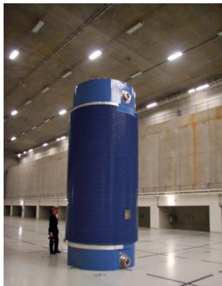
**Castor-Behälter für hochradioaktiv verbrauchte Brennelemente, rund 140 Tonnen schwer, Foto: BZG**
